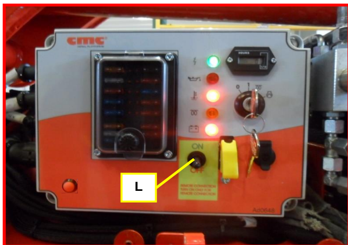
Afbeelding 115: kastje start/stop op het onderstel.
