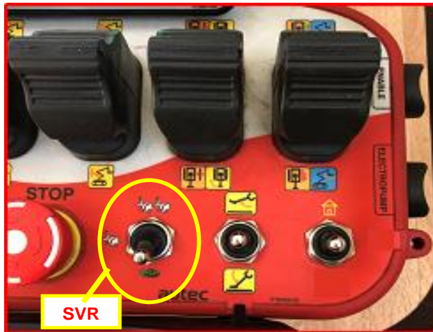
Afbeelding 43: keuzeschakelaar snelheid op afstandsbediening.
