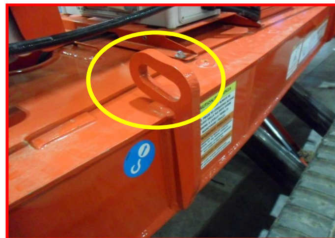
Afbeelding 41: bevestigingspunten op het onderstel.
